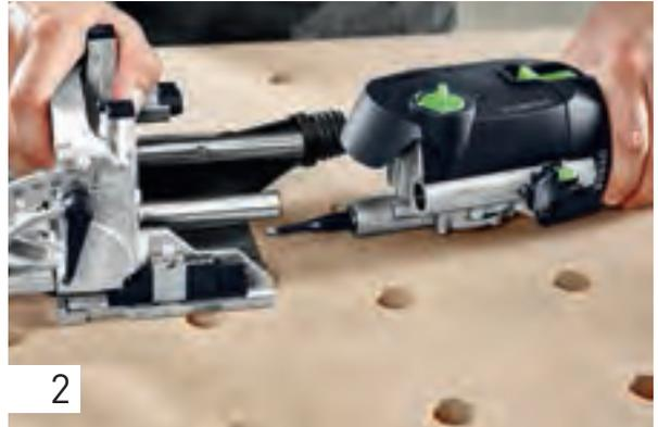
Motoreinheit und Führungsgestell voneinander lösen.
