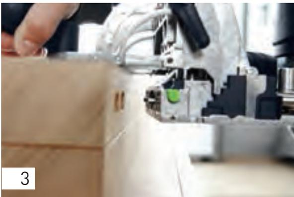
DOMINO Fräsungen in Tisch- oder Bettpfosten fräsen (schmale Lochbreite), mit der Frästiefe von 25 mm. Setzen Sie dabei eine Fräsung für den Spreizanker des Eckverbinders, die anderen für den Lastabtrag über klassische DOMINO Dübel.
