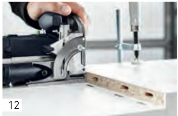
Nun stellen Sie die Frästiefe auf 25 mm um und fräsen die Dübellöcher in den Mittelboden – wieder unter Einsatz der Anschlagklinke für das erste Fräsloch (schmale Lochbreite).
