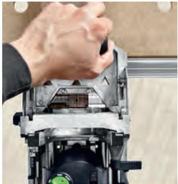
**DF 500:** Selbstverständlich gibt es die Möglichkeit, die Position der DOMINO Fräslöcher durch einfaches Anzeichnen und Anlegen der Maschine am Anriss durch das Sichtfenster zu definieren.
