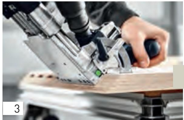
Nach dem Fräsen des ersten Lochs (Pin liegt hier an der Werkstückkante an) taucht der Pin jeweils ins Fräsloch und setzt so den nächsten Anschlag. Fräsen Sie das erste Loch passgenau, alle weiteren als Langloch mit Spiel.
