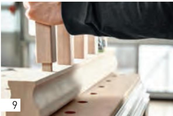
Setzen Sie nun, unter ausreichender Zugabe von Leim, die DOMINO Dübel in die Fräslöcher ein und verbinden Sie den Handlauf mit den Leisten.
