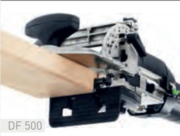
Der im Lieferumfang der DF 500 enthaltene Zusatzanschlag erhöht die Auflagefläche und reduziert den Seitenabstand der Anschlagklinken zur DOMINO Mitte von 37 mm auf 20 mm. Das ermöglicht passgenaues Positionieren von schmalen Werkstücken.
