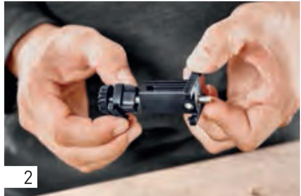
Zum Umbauen des Queranschlages auf die jeweilige Maschine wird die Klemmbacke am Anschlagzapfen so gedreht, dass diese auf DF 500 oder DF 700 ausgerichtet ist (vorne am Pin ist die jeweilige Maschine entsprechend markiert).
