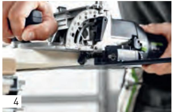
Daher wird bei dieser stumpfen Verbindung ein Fräsloch (stirnseitig) mit 25 mm Tiefe gefräst. Das weitere Fräsloch (flächig) mit 15 mm – so dass insgesamt die Dübellänge von 40 mm verarbeitet wird.
