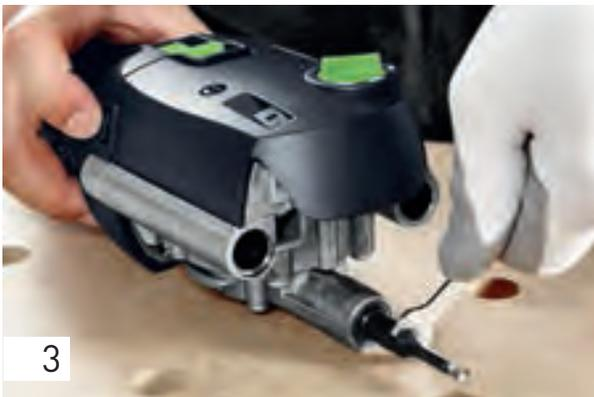
Spindelarretierung an der Motoreinheit gedrückt halten, mit dem Gabelschlüssel den Fräser lösen und abschrauben. Den neuen, gewünschten Fräser mit dem Gabelschlüssel eindrehen, dabei die Spindelarretierung gedrückt halten. Danach Spindelarretierung loslassen.
