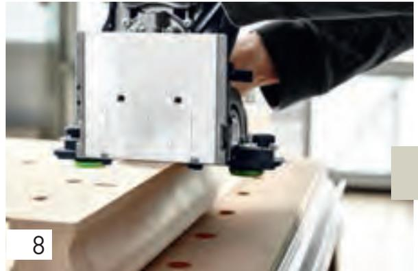
Und fräsen Sie – anlegend an der zweiten Markierung – die Fräslöcher in den Handlauf.
