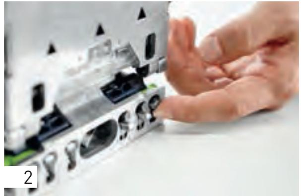
Es bietet sich an, in diesem Fall mit den Anschlagpins zu arbeiten. Wählen Sie die Pins je nach gewünschtem Lochabstand. Achten Sie dabei darauf, dass die Fräsung für den Eckverbinder einen Mindestabstand von 37 mm zum Werkstückrand hat. Sollten Sie also mit den Anschlagpins arbeiten, nutzen Sie mindestens den mittleren Pin.
