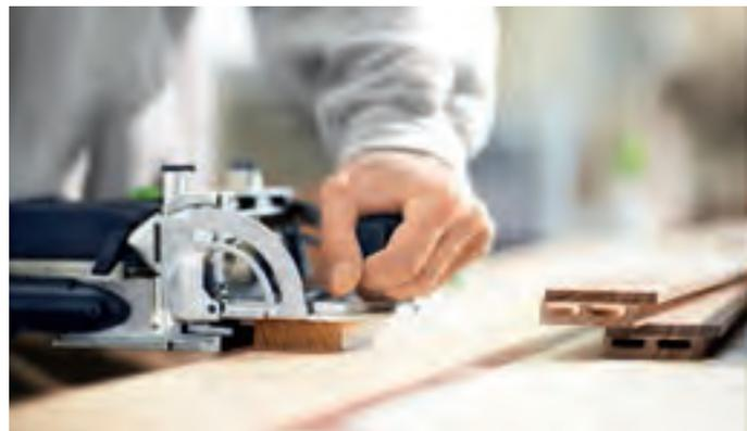
**TIPP** Sollte das Rahmenfries anschließend gefalzt oder genutet werden, muss die Falztiefe beim Fräsen der Dübellöcher vorher addiert werden – damit der Dübel trotz Falzung (bei der ein Teil der Tiefe des Dübellochs entfällt) später mittig sitzt.
