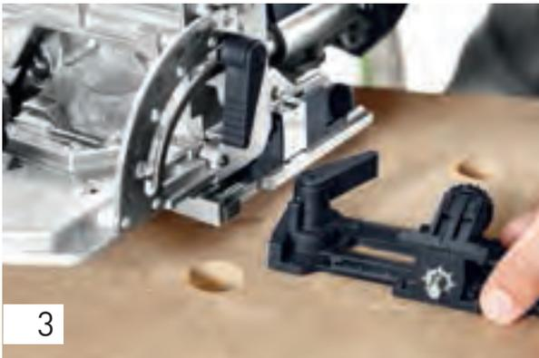
Montieren Sie nun den Queranschlag gemäß Bedienungsanleitung an der Dübelfräse. Wir verarbeiten im vorliegenden Beispiel Dübel von 6 x 40 mm.
