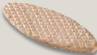
Flachdübel werden schnell – und meist mit Handmaschinen – nach Anriss positioniert. Da die Flachdübel kürzer sind als die gefrästen Schlitzlöcher, ist ein leichter Versatz beim Einfräsen kein Problem. Die Verbindung ist verschiebbar. Allerdings verlangt dieser Vorteil ein zusätzliches Ausrichten beim Verleimen.
