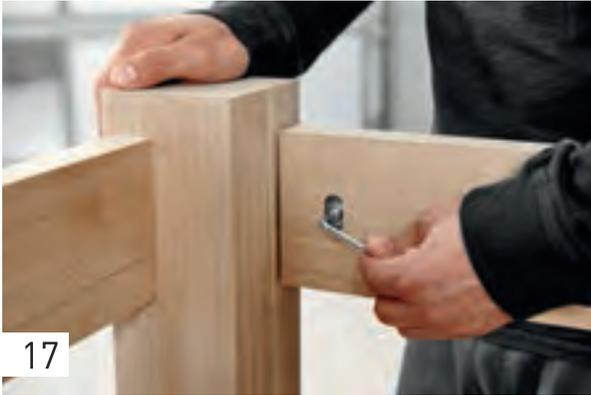
Verbindung mit einem 4-mm-Inbusschlüssel festziehen.
