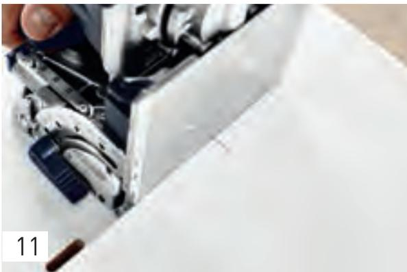
Für die weiteren Dübellöcher stellen Sie die Lochbreite auf Langloch um und zeichnen sich die Dübelpositionen mit einem einfachen Anriss auf dem liegenden Mittelboden an. Setzen Sie jetzt die Dübelfräse am Anriss an. Nutzen Sie dabei die auf der Unterseite der Dübelfräse angebrachten Markierungen, indem Sie die mittlere Markierung am angezeichneten Anriss anlegen.
