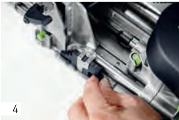
Fräshöhe einstellen: Der Abstand von der Anschlagklappe bis zur Fräsermitte sollte die Hälfte der Plattenstärke betragen. Bei einer Plattenstärke von 38 mm stellen Sie also die Fräshöhe auf 20 mm ein.
