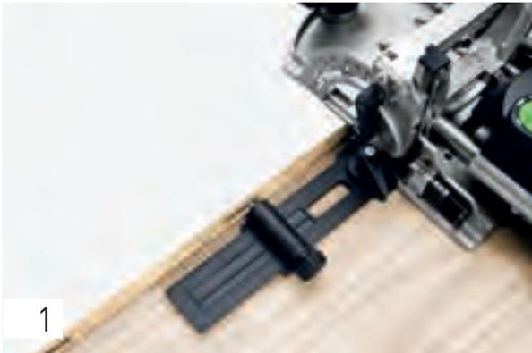
Bei größeren Werkstückbreiten und größeren Lochabständen kann ohne Anzeichnen mithilfe des Queranschlages einfach über das Pin-Anschlagsystem gearbeitet werden.
