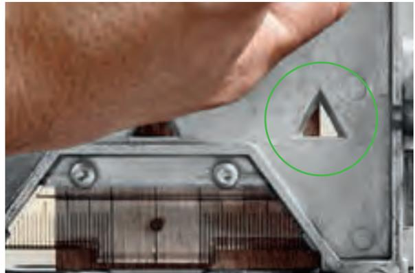
Dabei wird der Rand des Werkstückes oben im dreieckigen Sichtfenster der Maschine sichtbar. Sollten Sie die Anschlagklinken nicht benötigen, drücken sich diese automatisch während des Fräsvorgangs weg.
