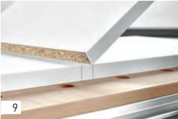
Legen Sie das obere Seitenteil zur Seite. Positionieren Sie den Mittelboden an der angezeichneten Position und klappen Sie ihn nach rechts oder links, sodass die Ober- oder Unterkante des Mittelbodens ausgerichtet zur entsprechenden Markierung zu liegen kommt. Spannen Sie beide Werkstücke (Mittelboden und Seitenteil) fest.
