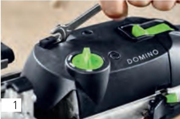
Zum Fräserwechsel unbedingt Netzstecker ziehen. Dann Entriegelungshebel mit dem Gabelschlüssel (im Lieferumfang enthalten) anheben, bis er hörbar einrastet.
