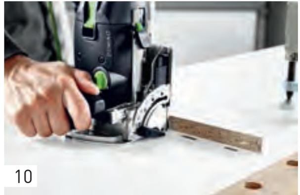
In unserem Beispiel sind Mittelboden und Seitenteil frontbündig und werden entsprechend festgespannt. Stellen Sie nun die Winklereinstellung der Dübelfräse auf 0° und die Frästiefeneinstellung auf 15 mm. Nun fräsen Sie das erste Dübelloch mit der schmalen Lochbreite unter Nutzung der Anschlagklinke in das liegende Seitenteil.
