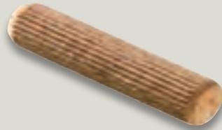
Runddübel zählen zu den wichtigsten Verbindungselementen im Möbelbau, mit denen sich Holzverbindungen auf Anhieb sicher ausrichten lassen. Da Runddübel keinerlei Versatz erlauben, erfolgt das exakte Bohren meist auf stationären oder halbstationären Maschinen.
