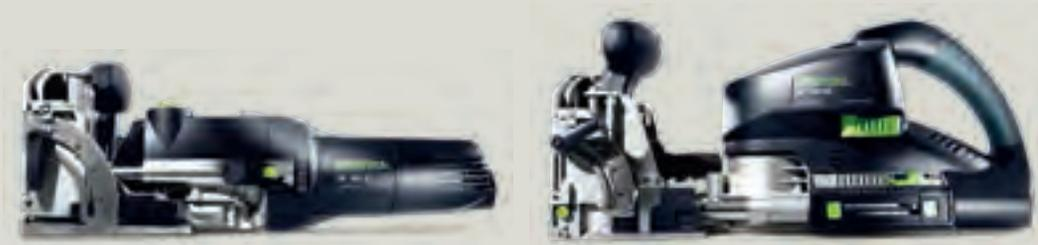
**Zwei Fräsen – ein Prinzip.** Die DOMINO Dübelfräse gibt es in zwei Größen, als DF 500 für Dübelgrößen von 4 x 20 mm bis 10 x 50 mm, perfekt geeignet für den Platten- oder Korpusbau sowie für leichte Rahmen- oder Gestellverbindungen. Oder als DOMINO XL DF 700, die es ermöglicht, Dübelgrößen von bis zu 14 x 140 mm zu verarbeiten. Dadurch eignet sich die DOMINO XL ideal für den Massivholzmöbel- und Türenbau und die Herstellung stabiler Massivholzverbindungen.
