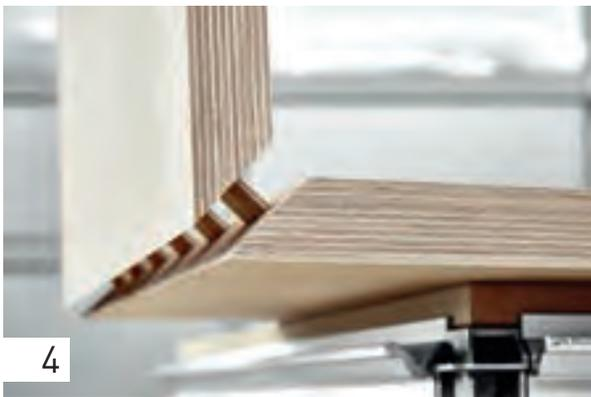
Setzen Sie dann die Werkstückteile zusammen, verleimen Sie die Dübel dabei sorgfältig.
