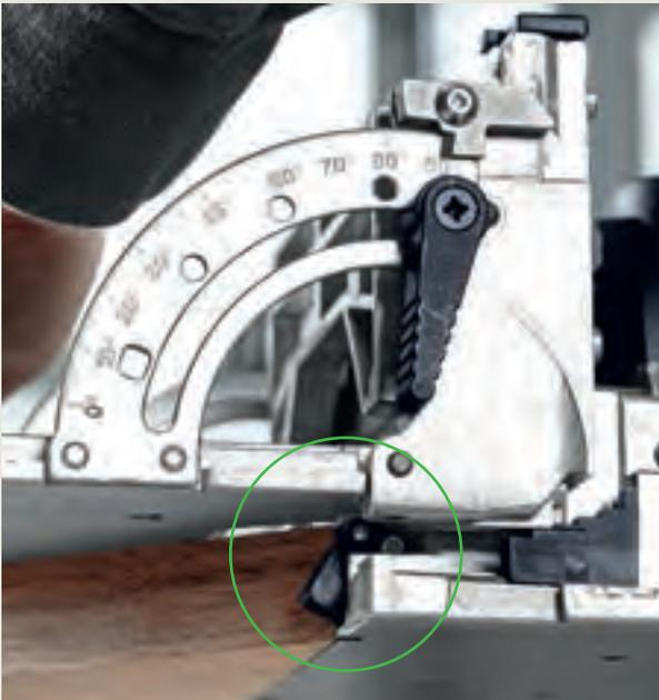
Am einfachsten ist es, die Position der Dübellöcher durch die Nutzung der integrierten Anschlagklinken schnell und wiederholgenau für beide Werkstückteile zu definieren. Der Abstand zwischen der Anschlagklinke und der Fräsermitte beträgt 37 mm. Setzen Sie die DF 500 mit einer Anschlagklinke an den Rand des Werkstückes.
