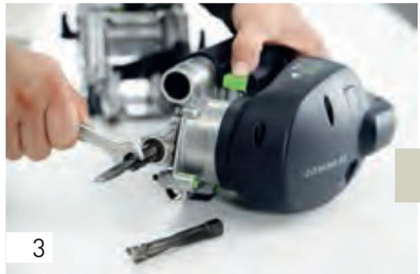
Setzen Sie den 14-mm-Fräser ein.
