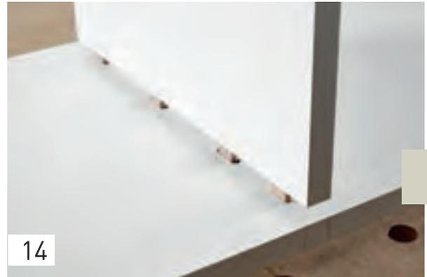
Für das zweite Seitenteil gehen Sie ebenso vor. Setzen Sie dann die DOMINO Dübel in die Fräslöcher ein und fügen Sie – unter der Zugabe von Leim – Ihr Werkstück zusammen.
