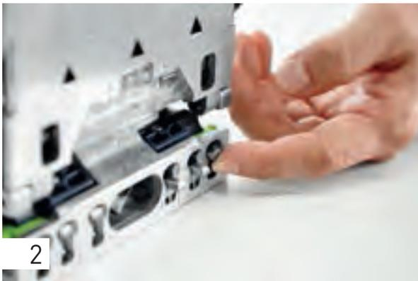
Wählen Sie je nach Werkstück individuell mit dem Pin-Anschlagssystem den Lochabstand. Im Beispiel wird mit den beiden mittleren Pins gearbeitet, so entsteht ein Lochabstand von 37 mm.
